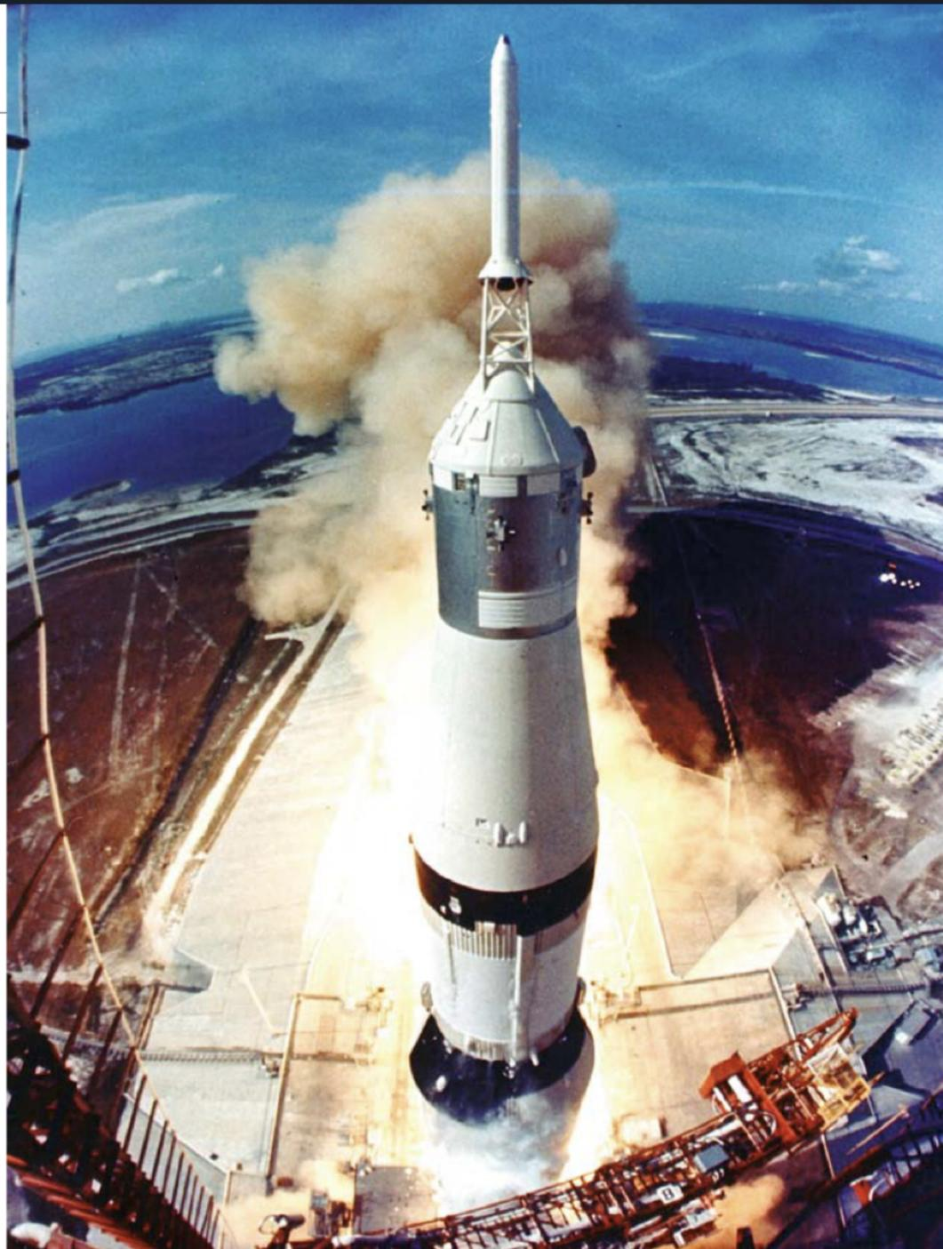
16 juillet 1969, 13 h 32 UTC. La fusée Saturn V, haute de 110 mètres, composée des trois étages du lanceur, du module de commande et de service (CSM) et du module lunaire (Lem), s'arrache à l'attraction terrestre. Onze minutes et 39 secondes après le décollage, les deux premiers étages ont été éjectés, les moteurs du troisième s'arrêtent. Apollo 11 est désormais en orbite basse, à 190 kilomètres de la surface planétaire.
